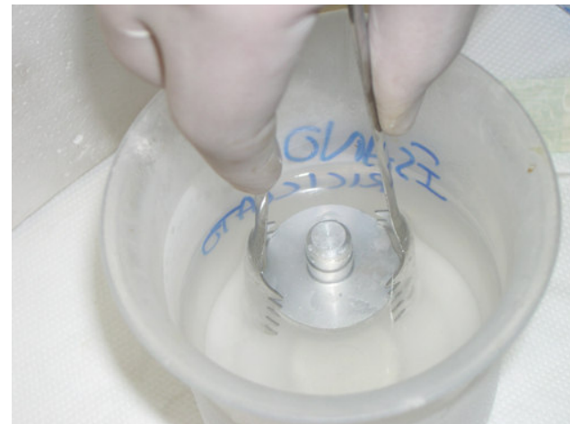
3. Immersione in esano raffreddato con azoto liquido
