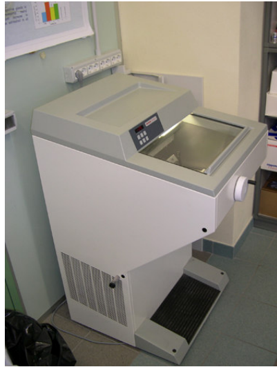
a. Posizionamento nel criostato (-30°C)
