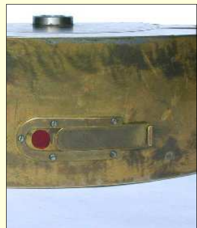
Figura 18 - Foro per il controllo dell'avanzamento della pellicola.
