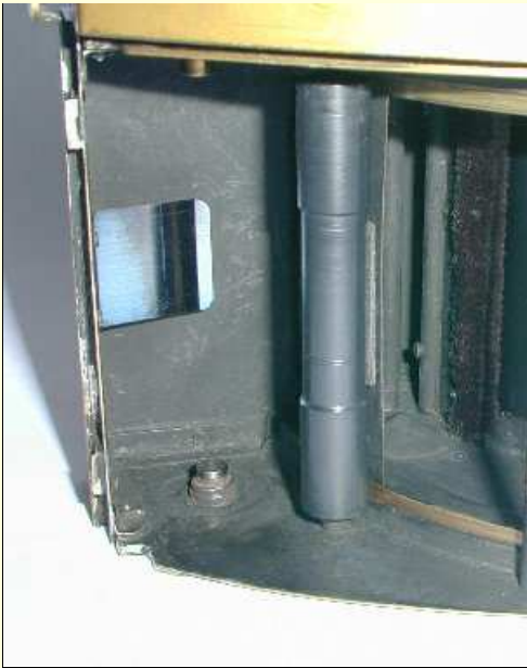
Figura 21 - Alloggiamento per il rullino nuovo della pellicola. Notate i perni su cui va inserito il rullo, la colonnetta rotante in PVC. Questa colonnetta è ampiamente scaricata al centro. Una lamina elastica preme la pellicola in corrispondenza della riduzione del diametro della colonnetta per conferirle l'assetto giusto e per evitare che essa esca dalle guide. La piccola lamina laterale in acciaio ha lo scopo di facilitare l'allineamento del rullo sui perni della macchina. All'interno si vede l'antina oscillante rivestita di velluto e la colonnetta a cui è avvitata. In basso sul fondo, è visibile il dorso oscurato della bolla inferiore.
