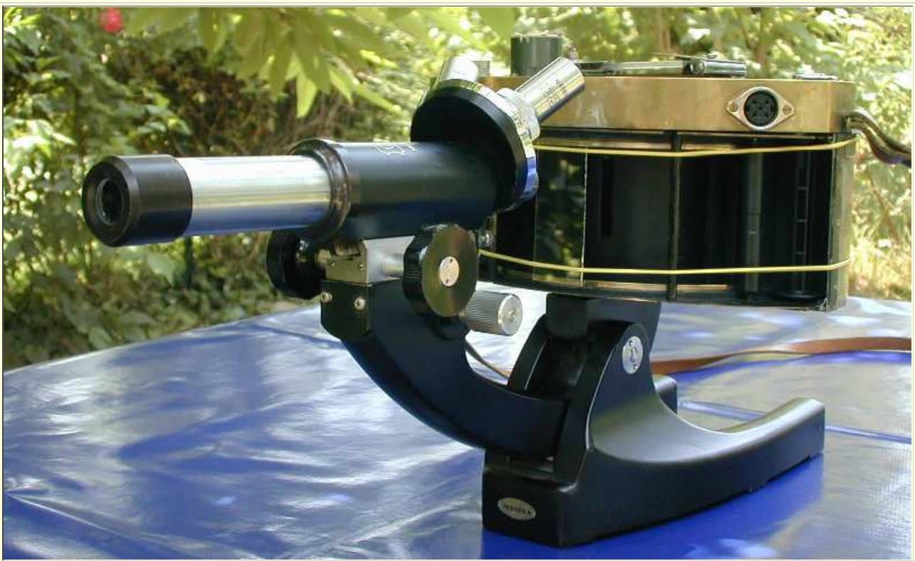
Figura 34 - Come usare un microscopio per regolare la posizione dell'obiettivo. Notate il vetrino fermato sulle guide da due elastici.
