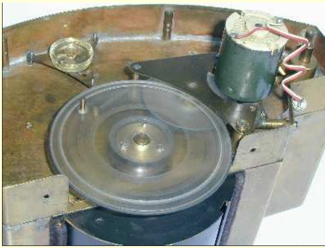
Figura 28 - Dispositivo per la rotazione del tamburo. Si noti la puleggia principale, la puleggia intermedia e il motorino elettrico. Più indietro è visibile la bolla montata su viti calanti. Il frontale è stato tolto per mostrare meglio la puleggia principale ed il tamburo.
