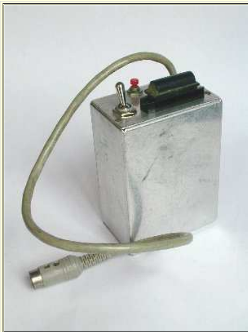
Figura 30 - Alimentatore della macchina fotografica. Contiene 6 batterie mezza-torcia da 1,5 V. Osservate il cavo e lo spinotto per il collegamento all'apparecchio, il deviatore per invertire la polarità della tensione, il connettore per passare da 9 V a 1,5 V, il pulsante rosso per erogare la tensione.
