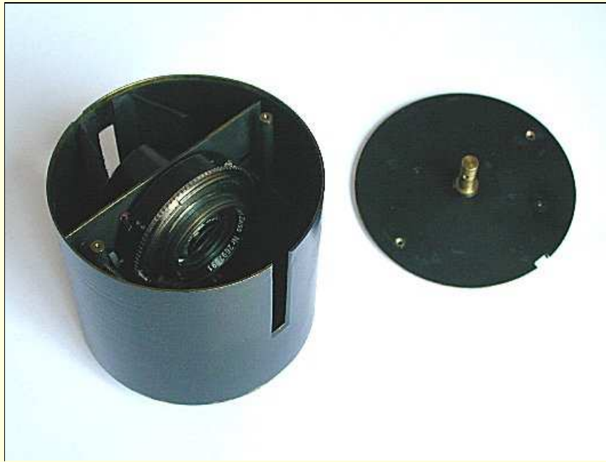
Figura 11 - Tamburo rotante. Il tappo superiore è stato tolto per mostrare l'obiettivo ed il dispositivo di centraggio.
