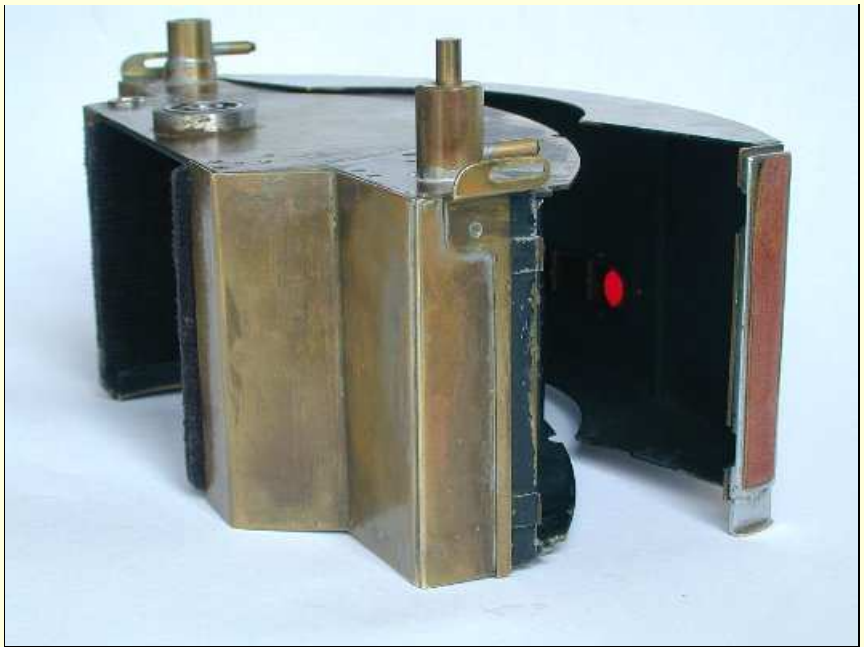
Figura 20 - Corpo macchina visto dal lato del dispositivo di chiusura.
