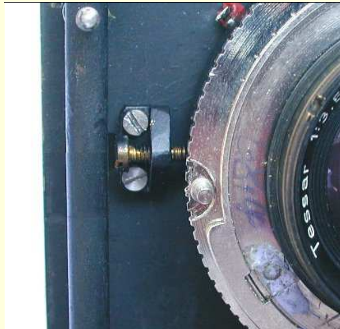
Figura 9 - Particolare della vite di regolazione della posizione orizzontale dell'obiettivo.
