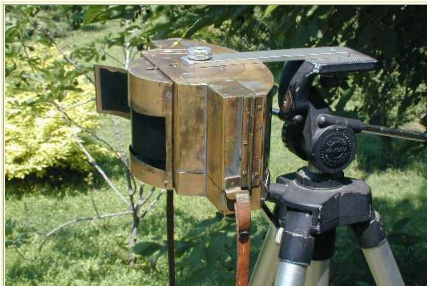
Figura 32 - Staffa per montare la macchina capovolta sul cavalletto. La freccia gialla indica la posizione della bolla inferiore.
