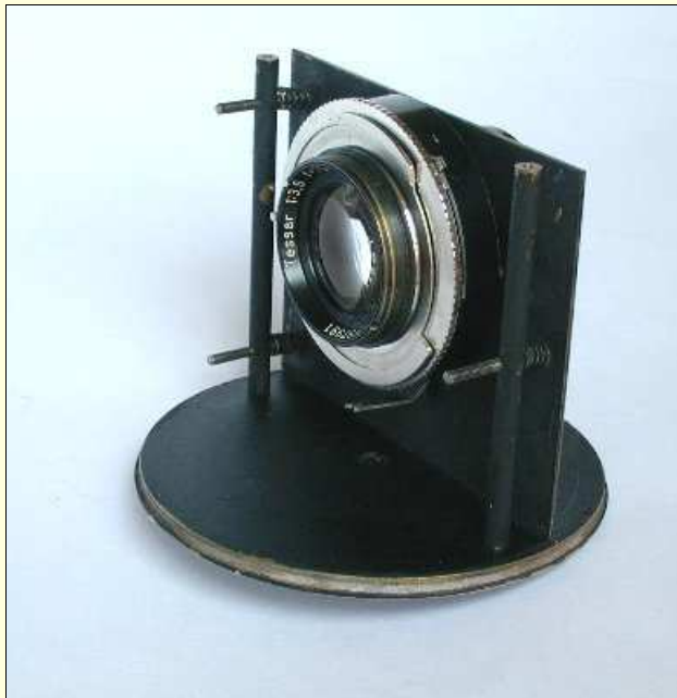
Figura 8 - Obiettivo montato su di una piastrina la cui posizione è regolabile per mezzo di tre viti calanti. Le due colonnette sono fissate ai tappi inferiore e superiore (rimosso) del tamburo (rimosso).
