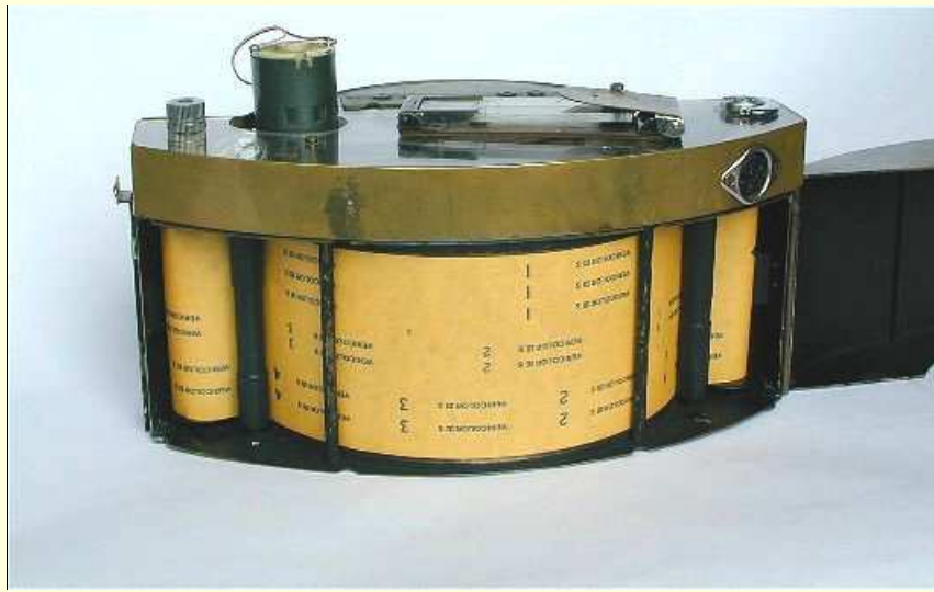
Figura 23 - Macchina aperta per mostrare la pellicola. Il senso di avanzamento è da sinistra verso destra. Le due colonnette centrali non hanno alcuna funzione per l'assetto della pellicola e servono solo a distanziare e a collegare le due piastre, superiore ed inferiore.
