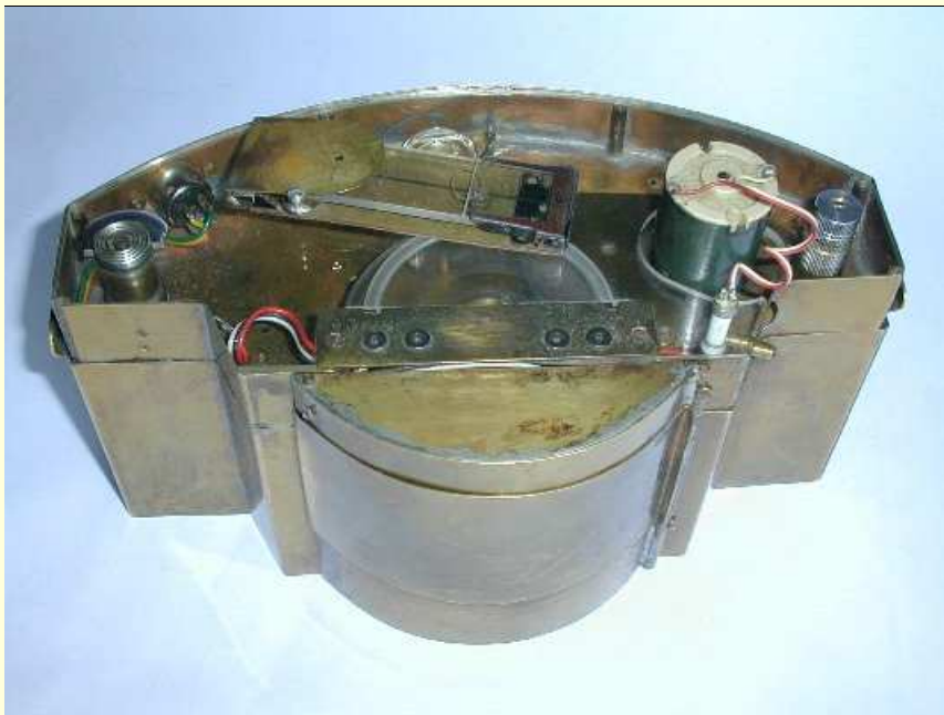
Figura 24 - Vano per il dispositivo di rotazione del tamburo. Esso è chiuso da un coperchio trasparente. Oltre al dispositivo di rotazione, vi sono i cavi e la bolla. Sopra è visibile il mirino ripiegato e le manopole di manovra.
