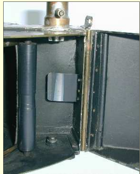
Figura 22 - Alloggiamento per il rocchetto su cui si avvolge la pellicola. Notate la colonnetta rotante in PVC, la lamina piana che appoggia sulla colonnetta e che determina il bordo dell'immagine. La lamina metallica piccola serve a facilitare l'estrazione del rullo esposto. Notate infine in basso la lamierina piegata che corre tra la piastra inferiore e la lamiera anteriore.
