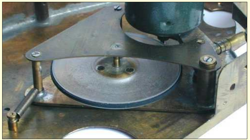
Figura 29 - Puleggia intermedia. Osservate sulla sinistra la molla di tiro contro la puleggia principale (rimossa). Si intravede l'albero del motorino contro la puleggia intermedia.
